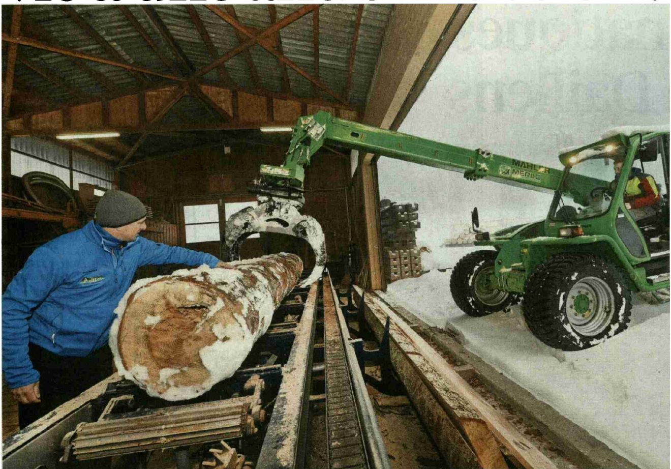
La nouvelle scie (ici Laurent Fivaz à g. et Nicolas Pollen dans le véhicule) permet de scier des billes longues de 10 mètres. Une ouverture latérale a été aménagée sur l'un des murs de la scierie pour faciliter l'acheminement du bois. CHANTAL DERVEY
